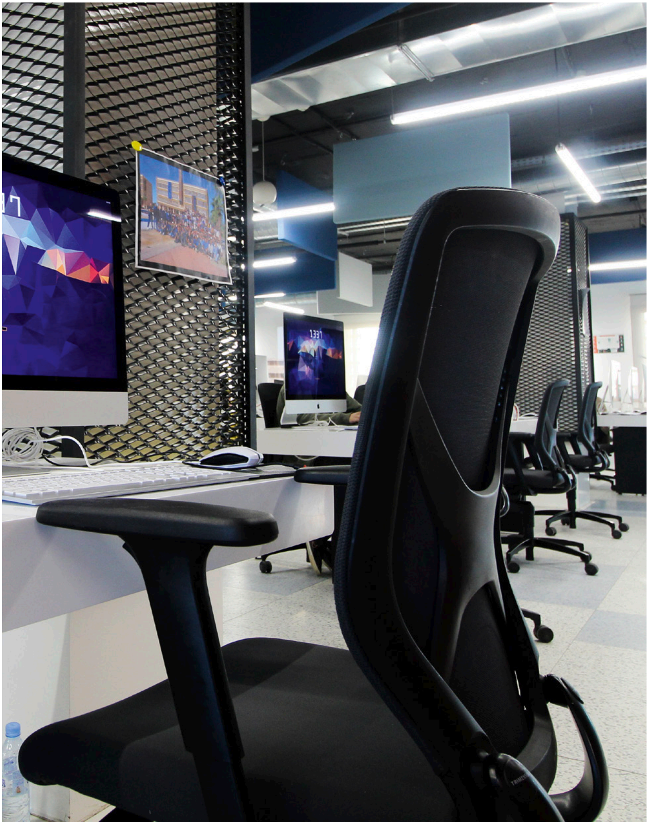
Eine 3-D-Kinematik mit Direktübertragung und Hightech-Verfahren wie die Fertigung des Sitz-Rückensystems mit 2-Komponenten-Technologie und Formstrick sorgen für freie Beweglichkeit in alle Richtungen. Bürostuhl IN (Design: wiege)
