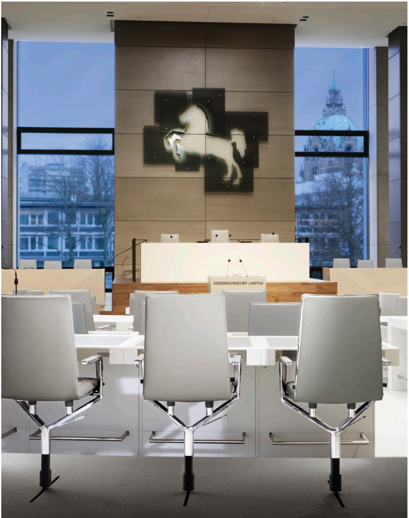
Für den Plenarsaal wurde der Konferenzsessel Sola (lizensiert von Davis Furniture, Design: Justus Kolberg) besonders angepasst. Bei der Mehrzahl der Stühle ist die Mittelsäule über eine Schiene in den Boden eingelassen, sodass sie immer mittig zum Tisch stehen und sich über eine Rückstellfeder automatisch parallel zur Tischkante ausrichten.
