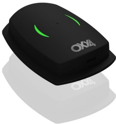
Abbildung 3: NIRS DR2-Sensor von Oxy4 ®
